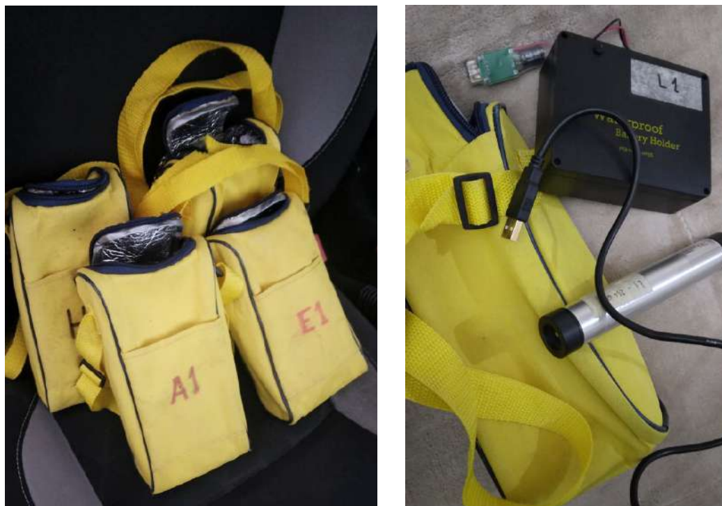
Figura 6. I quattro bat detector utilizzati in questo studio: si tratta del bat detector con i microfoni audio-ultrasonici Ultramic 384K di Dodotronic. Registrano i contatti ultrasonici full spectrum con una frequenza di 384 kHz e con file wav di durata di 5 secondi (su una scheda di memoria interna). L'autonomia – con power bank di 3 pile D- può arrivare a sette notti continuative, con registrazione su 8-9 ore per notte.
